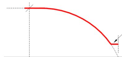
Velocità di rilascio calcolata a bordo, in considerazione delle caratteristiche della linea e del materiale rotabile
